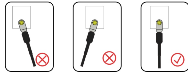
Figur 5-5 Sikring af, at kablerne er parallelle
